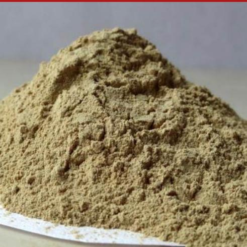
Claygrain é uma bentonita de sódio em pó, dissolvida, anidra, caracterizada por um teor de montmorilonite superior a 95%, com baixo yield-point (ponto de rendimento). O produto deve ser utilizado como tal para aumentar a quantidade de bentonita em zonas pontuais ou misturado com cimento e água ou apenas com água para se obter uma argamassa impermeabilizante ligeiramente expansiva, adequada para nivelamento de todos vãos em betão, antes do assentamento e enterramento da tela de bentonita Claytex.
