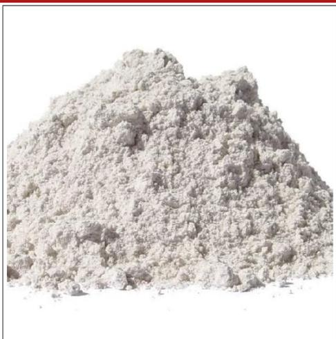
Microsilicatos selecionados (silica-fume) para a preparação de conglomerados de elevada densidade e desempenho (impermeabilidade, estabilidade química, resistência mecânica, etc.), para a preparação de argamassas, rebocos, microbetões e betões resistentes a sulfato, antilixiviação.
