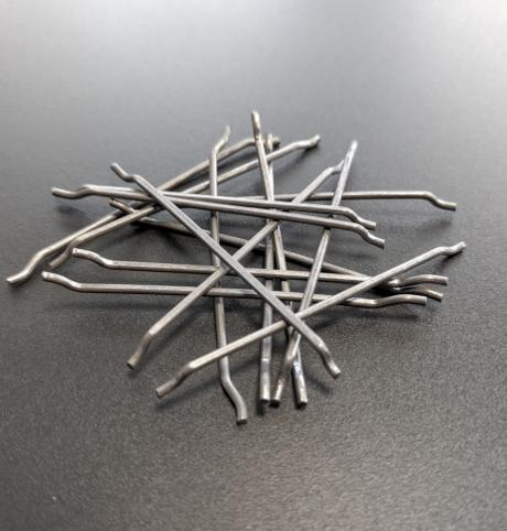
Fibras de aço carbono, obtidas do corte de fio metálico, com perfil e aderência melhorada, para reforço tridimensional, estrutural, de conglomerados de cimento em geral. A adição de Readymesh MF-500 permite aumentar notavelmente o desempenho mecânico do produto em relação à tenacidade, ductilidade e resistência a esforço, resistências às solicitações dinâmicas, comportamento mecânico com tração e flexão, mesmo pós-fissura, e resistência a colisões e ao desgaste.
