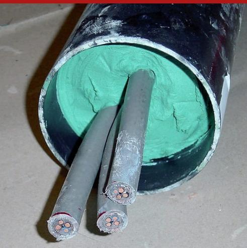
Composto vedante, de um componente, permanentemente plástico, ligeiramente expansivo (+10% de volume em contacto com água), para impermeabilizar furos subterrâneos, através dos quais passam um ou mais cabos e/ou tubos técnicos, nas estruturas das paredes. É extrudido em torno aos cabos que passam, mediante específica pistola doseadora para sacos de 600 ml, e posteriormente recoberto com argamassa tixotrópica Repar Tix G2.
